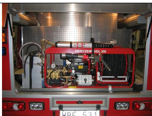
Inbyggnadsaggregats HDL 250-32, elstart, skum, 100 m slang, el-slangrulle, 650 l tank
