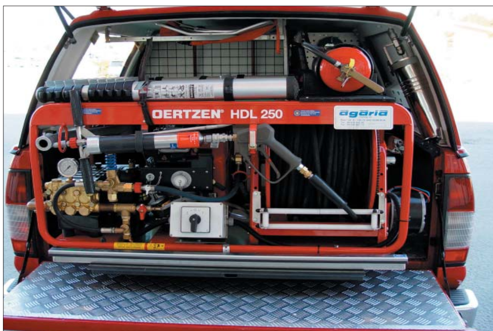
HDL 250, 32 l/min, som komplett inbyggnadsenhet i Nissan King Cab med 180 l tank innanför aggregatet. Släckningstid cirka sex minuter med 180 l tank.
